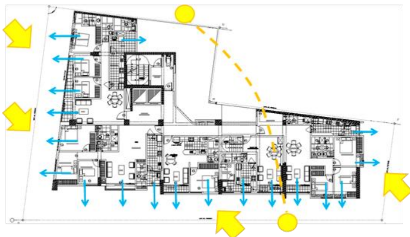
Figura 8. Disposición de las ventanas para una buena iluminación y ventilación natural.
