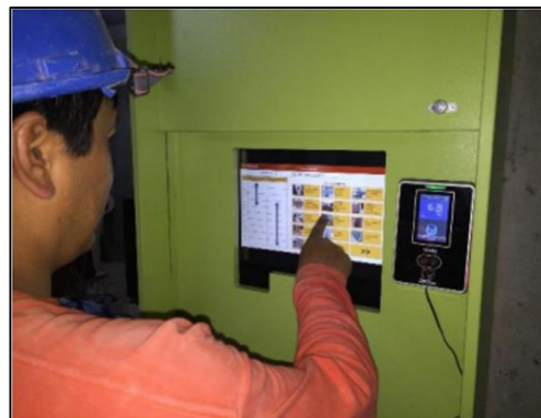
Figura 2. Auto-reporte del obrero mediante una pantalla táctil
